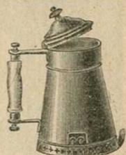
**Bouillotte** cuivre nickelé, intérieur étamé, poignée et bouton bois verni. Contenance 0 lit. 75. Ebullition en 8 minutes. Consommation 4 amp. 5, 110 volts. Sans fil. **40. »**
