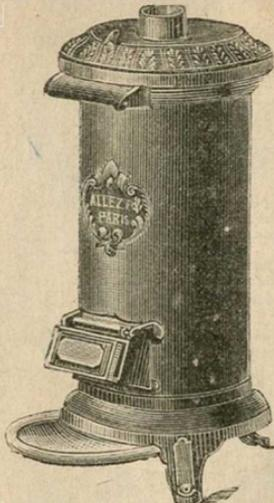
**Calorifère Godin, tôle et fonte, sans grille, tuyau dessus ou derrière, intérieur briques réfractaires au coke.**
